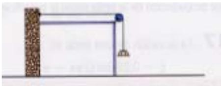
La tensión a que se ve sometida la cuerda es el peso de la masa suspendida,  $T = P = mg = 10 \cdot 9,8 = 98 \text{ N}$ .
